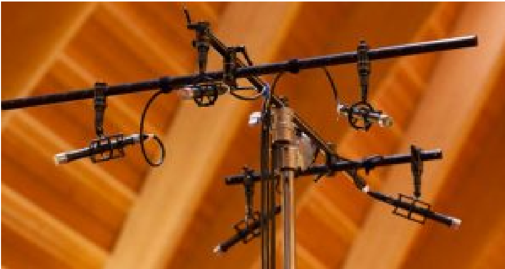
Bild 1 Die Aufstellung von Mikrofonen für Raumklang mithilfe des Decca Tree
